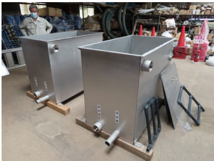
簡易緩速ろ過装置本体
